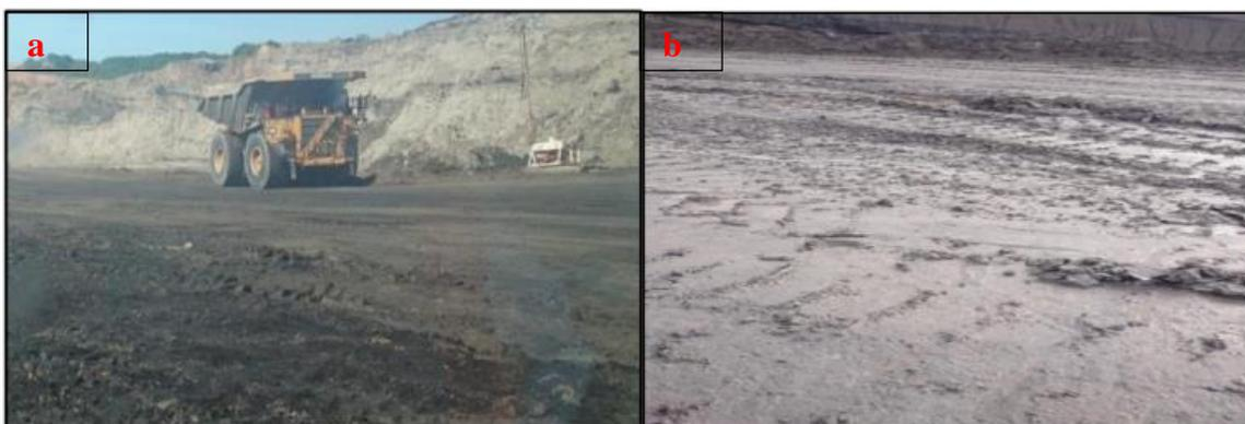
**Gambar 3.** Kondisi jalan tambang yang bergelombang (a) Kondisi kering, (b) Kondisi setelah hujan
